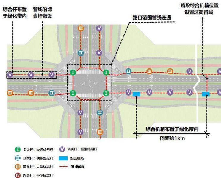
图 C.2 主干路布设示例图
