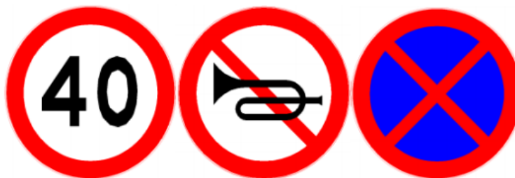
图4 限制速度标志、禁止鸣喇叭标志和禁止停车标志组合设置示例
